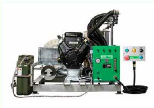
Le **U 40 HD M** est la plus grande unité UBV de la gamme de produits d'IGEBA. Son design robuste permet une utilisation fiable même dans des conditions extrêmes. Monté sur un châssis et sur 4 amortisseurs en caoutchouc il est spécialement approprié pour le montage sur un véhicule. 4 buses d'aérosol (activation/désactivation unique) permettent une variation de la direction de nébulisation.
